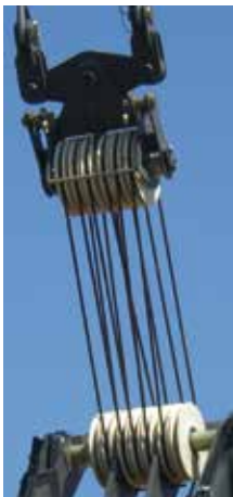
Seilrollenpaket in einem Gittermastkran
