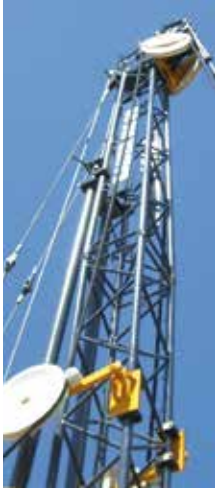
Schlauchumlenkrolle Ø 1100 mm an einem Erdbohrgerät
